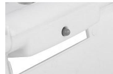
**Posse un dispositivo antivuelco,** que corta la alimentación electric cuando este se inclina en mas de 15° del plano, evitando de esta manera accidentes domésticos
